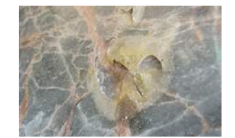
ウレタン塗装が劣化し剥がれた例 (弊社商品はポリウレタン塗装をいたしていません。)
