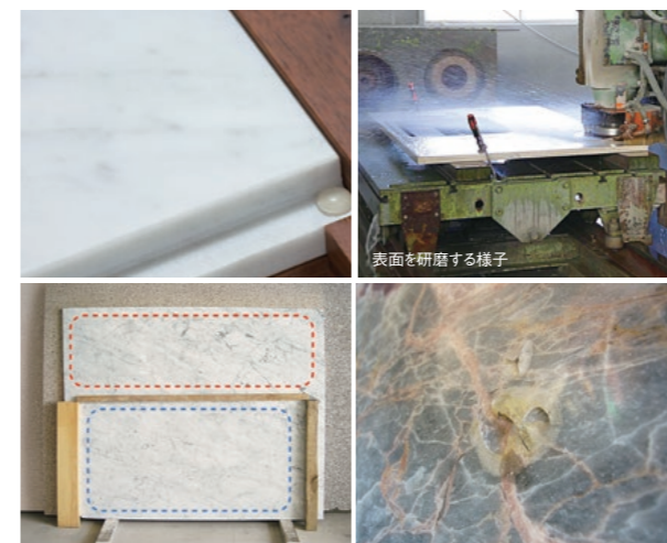
目が粗い部分(赤枠)を避け、綺麗な部分(青枠)のみをトリミングして使用します
